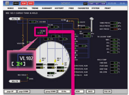
バルブコントロール
