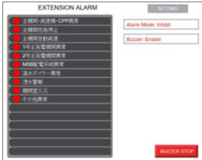
各部屋に設置している延長警報盤を擬似的に端末表示する機能です。ただし、船級要求で乗組員居室装備の延長警報盤の代用とはなりません。(併用は可能)
