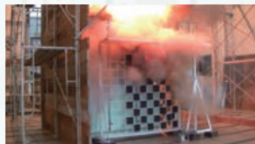
31.5kV 1sec JSB-5 内部アーク試験
